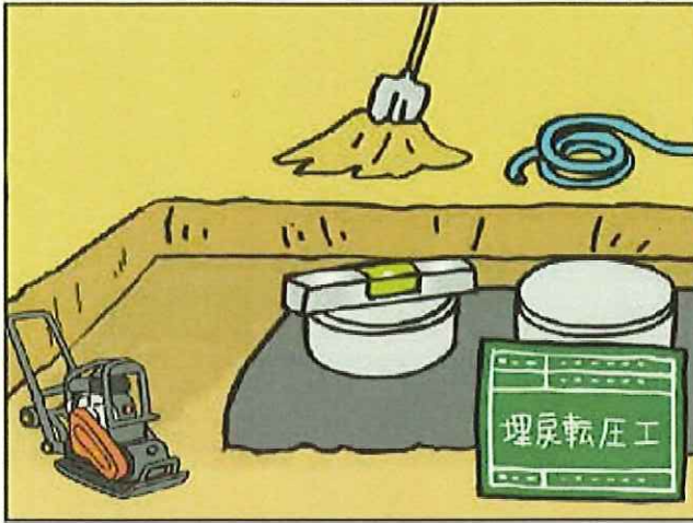
工事写真10 埋め戻し・水締め・転圧 (イラスト4)
